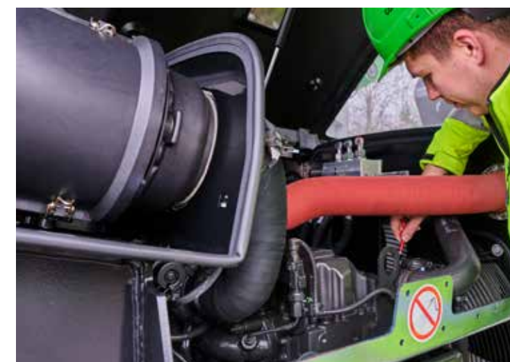
Mit einem Handgriff geräumiger Zugang zum Motorraum. Das Seitenblech der Motorgondel ist zusätzlich aufklappbar.
